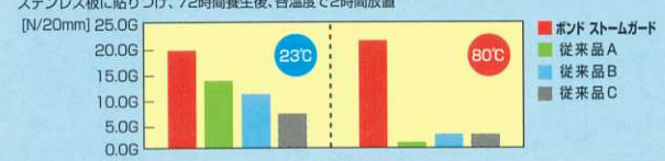
各温度雰囲気下における180度はく離接着強さ(粘着剤の軟化)
